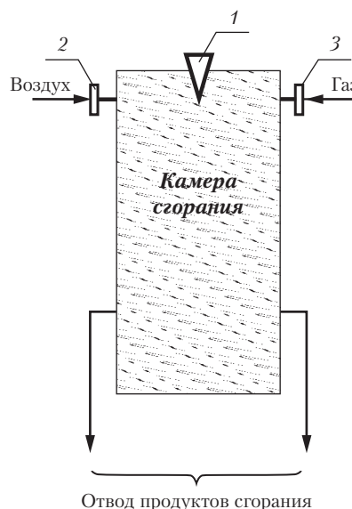
Рис. 8. Котел для пульсирующего метода сжигания газа:
